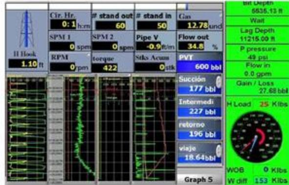
En la primera línea son los sensores de flujo, y es importante utilizar un sensor de flujo magnético, tanto en el punto (entrada y salida) para detectar bien cualquier variación en el flujo, y detectar la temprana posible la patada.
